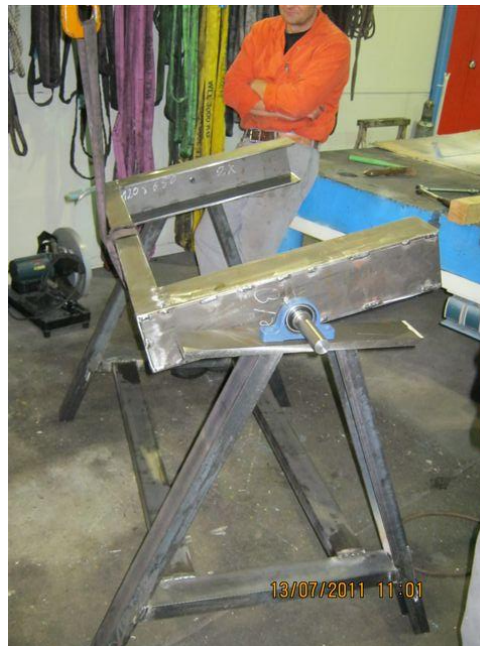
Abbildung 19: Wendevorrichtung für Stabstähle
