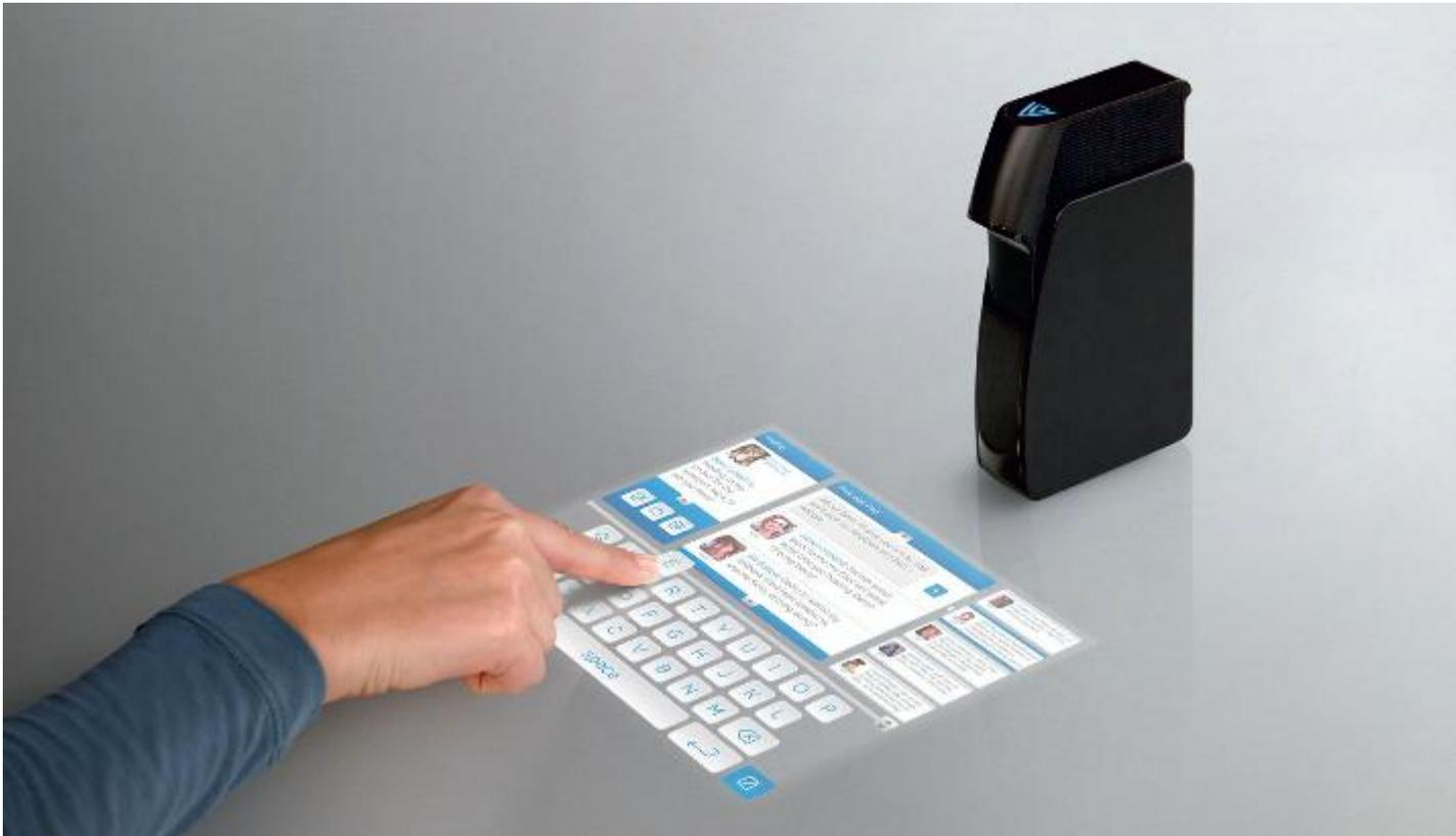
Eine virtuelle Tastatur wird auf eine physische Unterlage projiziert und mittels Stift oder Fingern bedient. Es sollte nicht in die Luft projiziert werden, da die taktile Rückmeldung fehlt.
