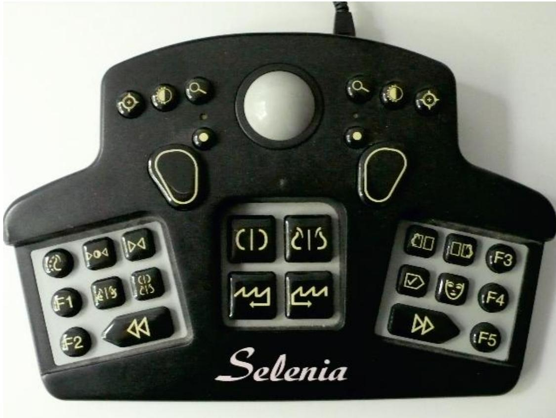
Ein speziell gestaltetes Function-Pad für die Befundung von Mammographien. Das Umschalten zwischen den einzelnen Bildern, z.B. Voraufnahmen und aktuellen Aufnahmen, wird dadurch unterstützt (Quelle: MeVis Breastcare).
