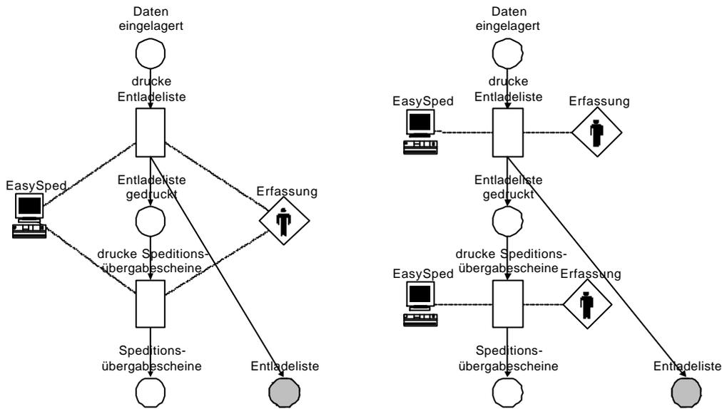
Abbildung 5.2-6: Vermeidung von Kantenüberschneidungen durch Verdoppelung von Symbolen
