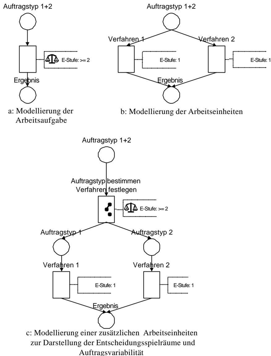
Abbildung 3.2-7: Modellierung von Arbeitsaufgaben, Arbeitseinheiten und Stufen der Planungs- und Entscheidungserfordernisse (E-Stufen)
