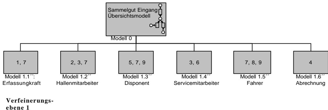
Abbildung 5.2-4: Baumstruktur der hierarchischen Zerlegung des Geschäftsprozesses Sammelgut-Eingang in Teilmodelle für Arbeitsaufgaben je organisatorische Einheit
