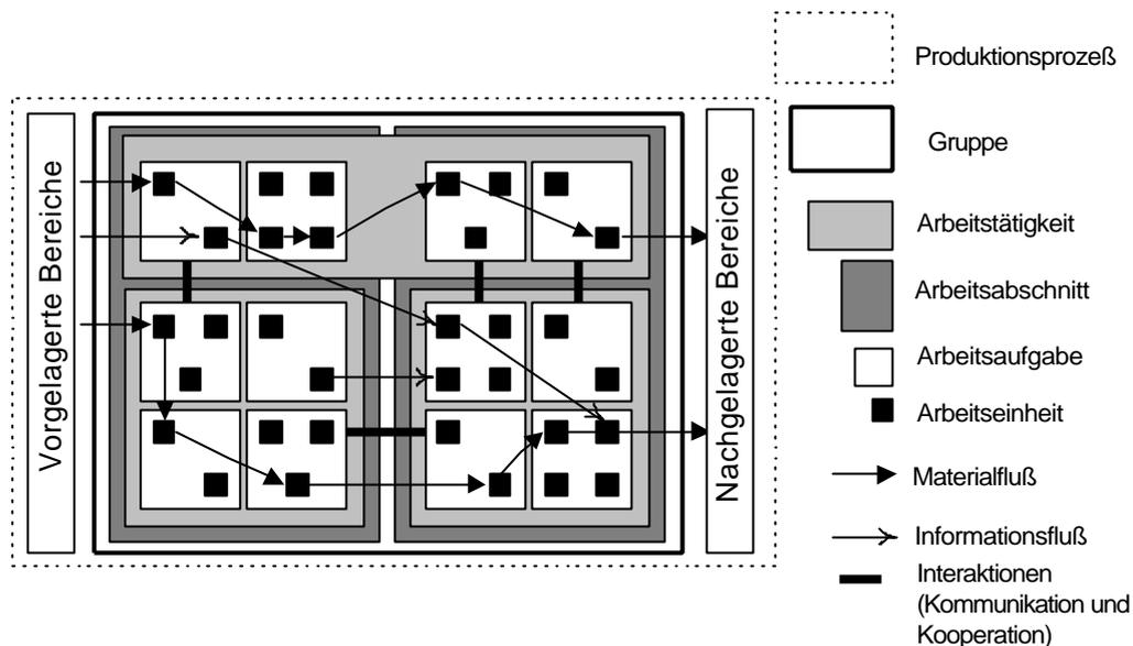
Abbildung 5.2-5: Integrierte Modellierung von Material- und Informationsflüssen sowie von Arbeitsaufgaben und Arbeitstätigkeiten im MSG [Luczak et al. 1996, S. 73]
