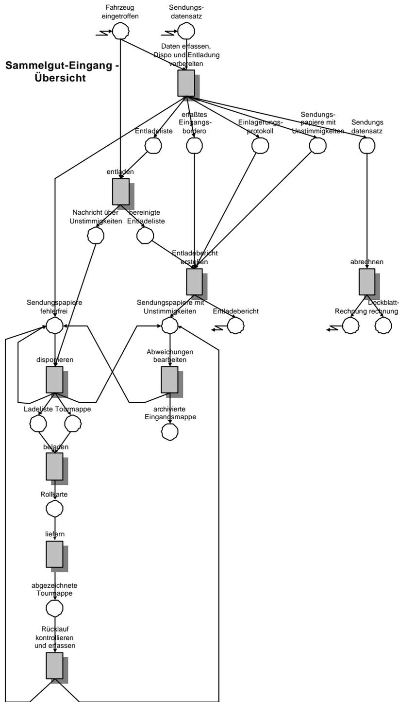
Abbildung 5.1-6: Grobes Übersichtsmodell eines Geschäftsprozesses in FUNSOFT-Notation mit durch Schattierung und graue Hinterlegung markierten Symbolen, die in Untermodellen verfeinert werden.
