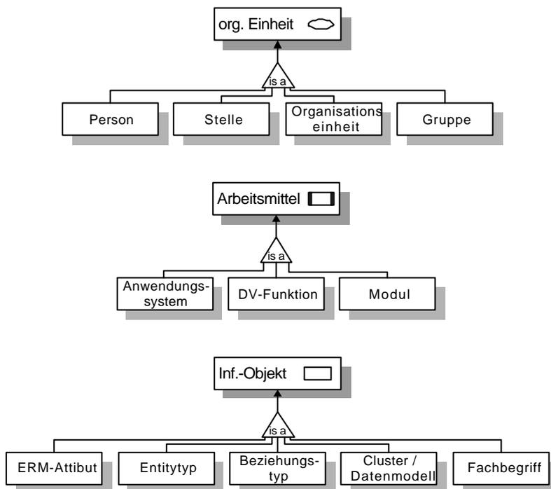
Abbildung 3.1-1 : Generalisierung der „Objekttypen“ der eEPK
